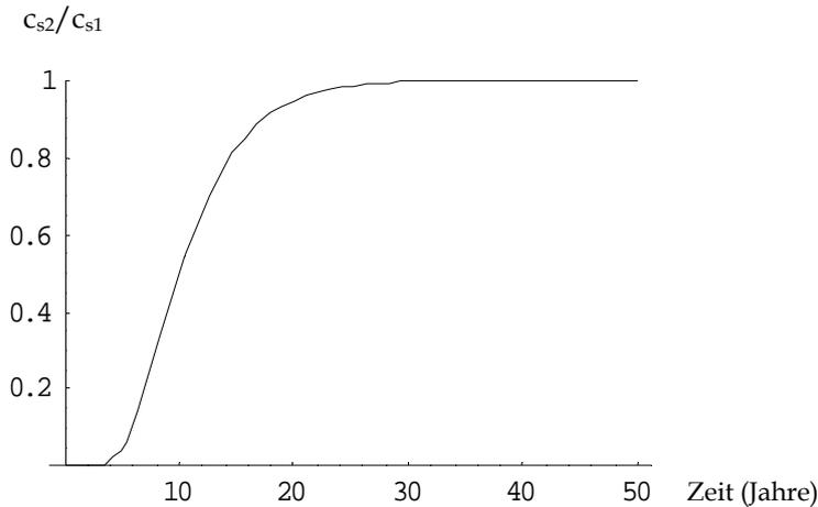
Abb. 3: Schadstoffkonzentration am Ort der Beurteilung; Annahme: unbegrenzte Emissionsdauer der Quelle, konstante Quellkonzentration, kein Abbau auf dem Transportweg
