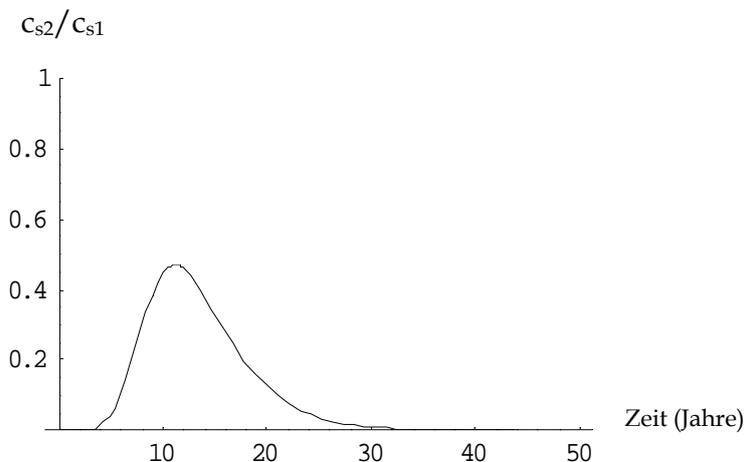
Abb. 4: Schadstoffkonzentration am Ort der Beurteilung; Annahme: auf 5 Jahre begrenzte Emissionsdauer, konstante Quellkonzentration, kein Abbau auf dem Transportweg
