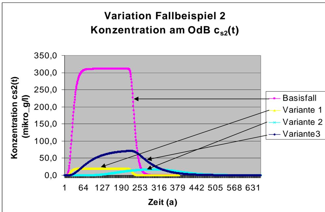
**Abb. 51: Darstellung des Konzentrationsverlaufs am OdB für die Varianten des Beispiels 2**
