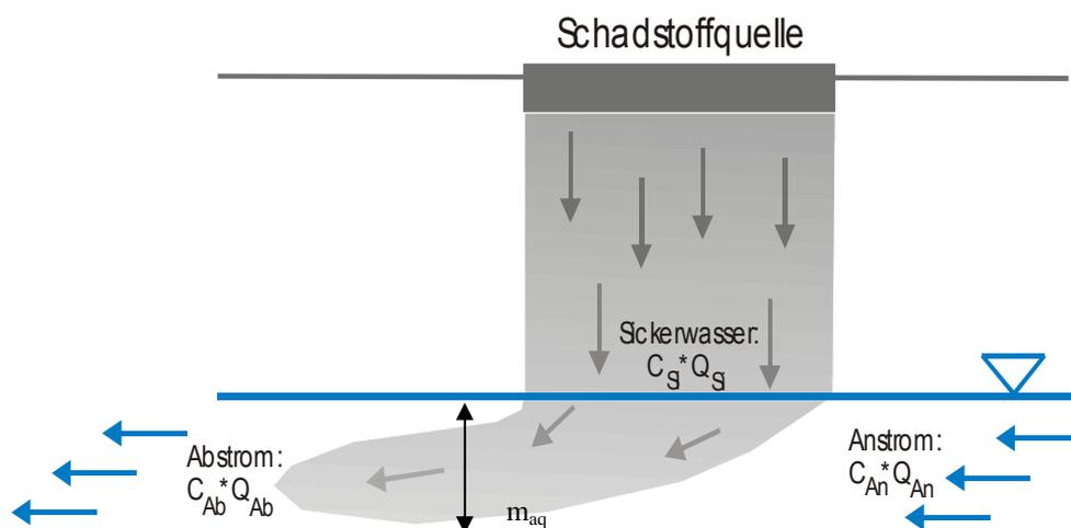
Abb. 6: Massenbilanzbetrachtung beim Eintritt einer Sickerwasserfracht in das Grundwasser (Prinzipische Skizze)
