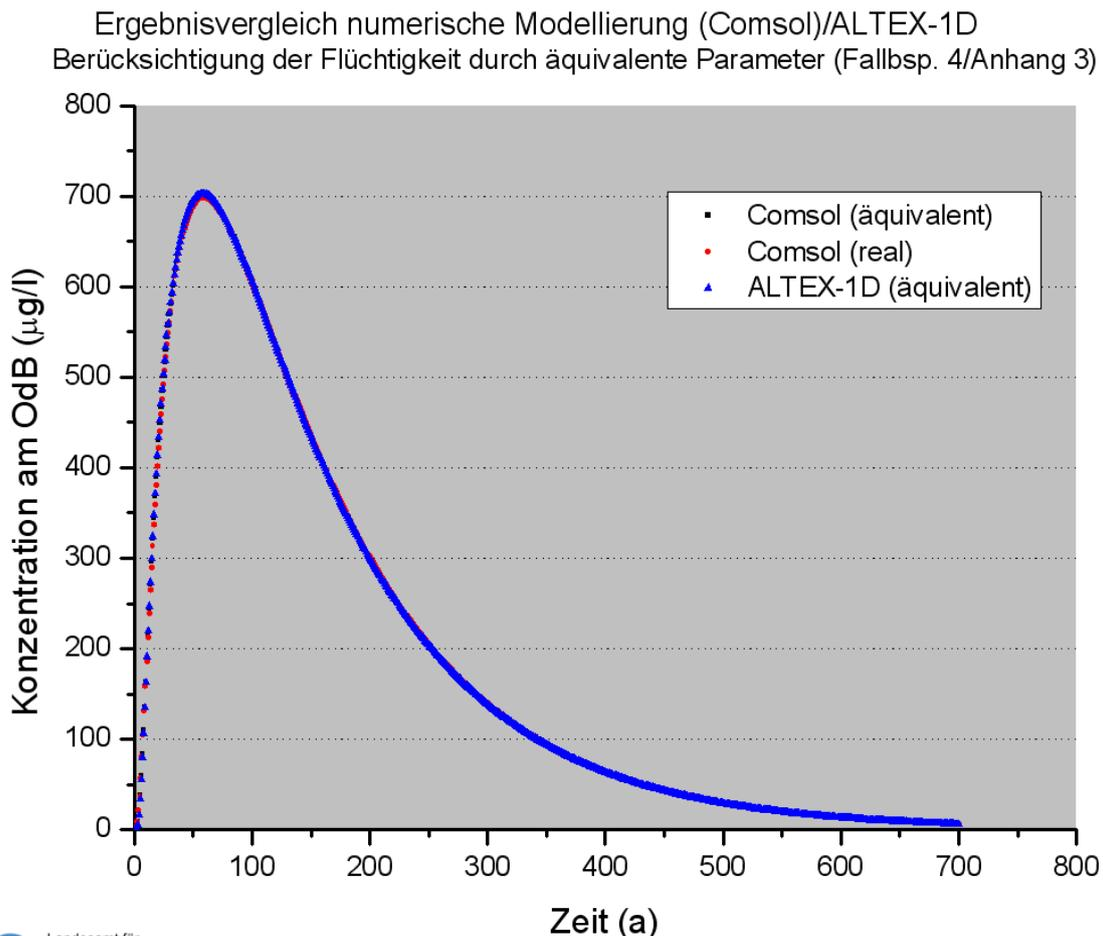
Abb. 60: Vergleich von Ergebnissen von ALTEX-1D und Comsol für das Fallbeispiel 4 (Berücksichtigung der Flüchtigkeit mittels äquivalenter Parameter)
