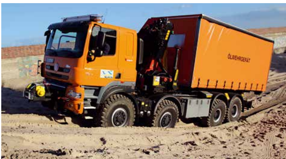
Neues Spezialfahrzeug für die Bekämpfung der Folgen von Schadstoffunfällen: Mit vier angetriebenen Achsen, Kran und Hakenliftsystem ist der TATRA-LKW – hier mit Ölwehrgütercontainer – vielseitig einsetzbar.
