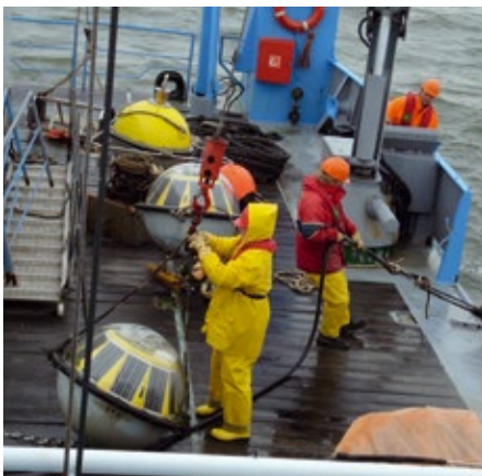
Unentbehrliche Helfer: Messbojen bestimmen Höhe und Richtung der Wellen.
