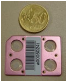
Wirkungsvolle kleine Messgeräte: Thermolumineszenzdosimeter
