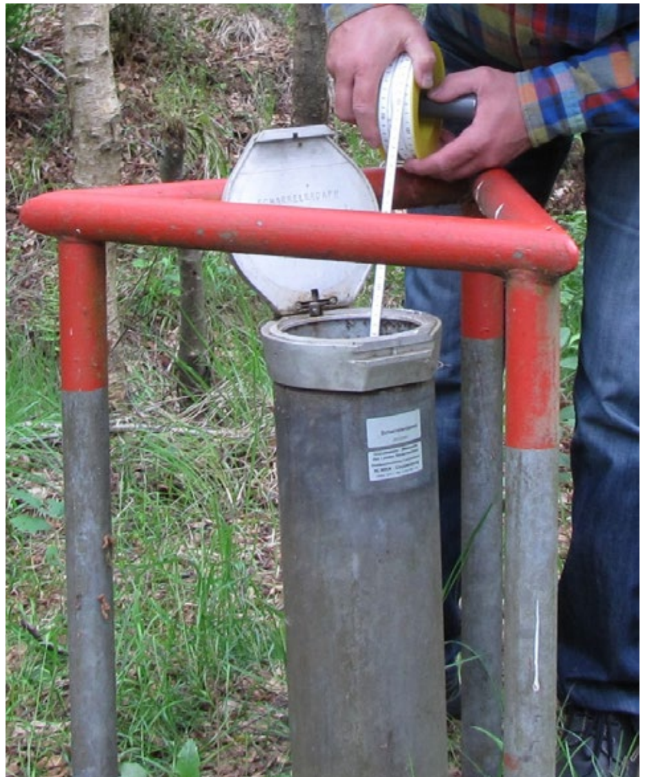
Der NLWKN betreibt mehr als 3500 Grundwasser-Messstellen: Hier wird der Grundwasserstand mit Hilfe eines Lots gemessen.
