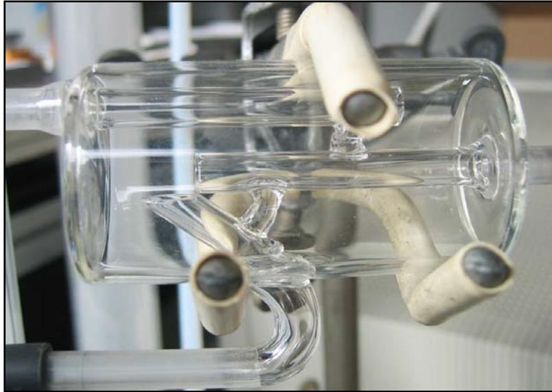
**Abbildung 2.26:** Miniaturisierter Gasmischer für Nullluft und Prüfgas (Mischkammer), Eigenbau IfT.
