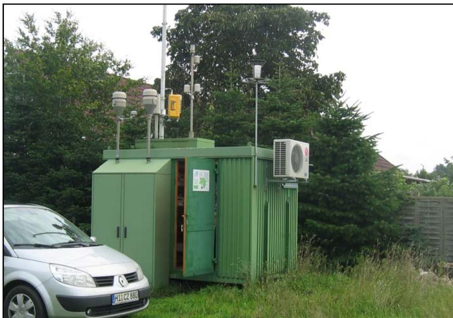
**Abbildung 2.18:** Station Bösel August 2006, Blick aus nordwestlicher Richtung. Es sind die Einlässe für die DIGITEL-Filternsammler DHA-80 und die „Werkzeugkiste“ mit dem UBA-Minidenuder zu erkennen.
