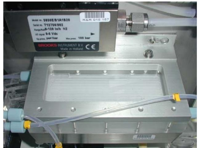
Abbildung 2.8: Ammoniakmesssystem AiRRmonia®, links Spritzenpumpe, rechts zur Teflonmembran offenes Kapillar-Kanalsystem (Denuder) zur Abscheidung von  $\text{NH}_3$  aus der Probenluft.
