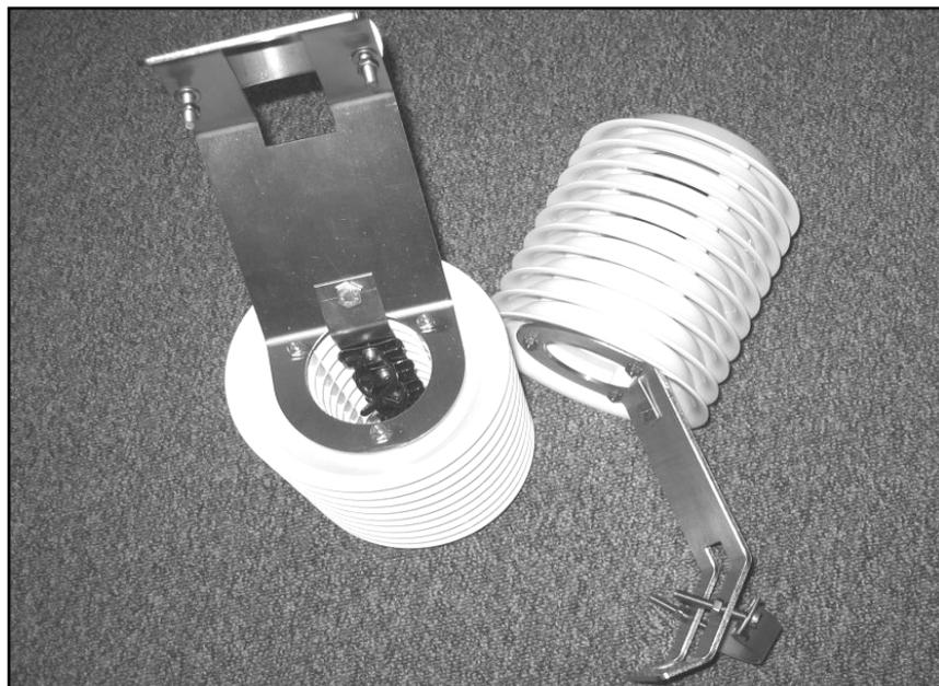
**Abbildung 2.9:** Beprobungsgehäuse für die Aufnahme von bis zu vier Diffusionssammlern nach FERM.
