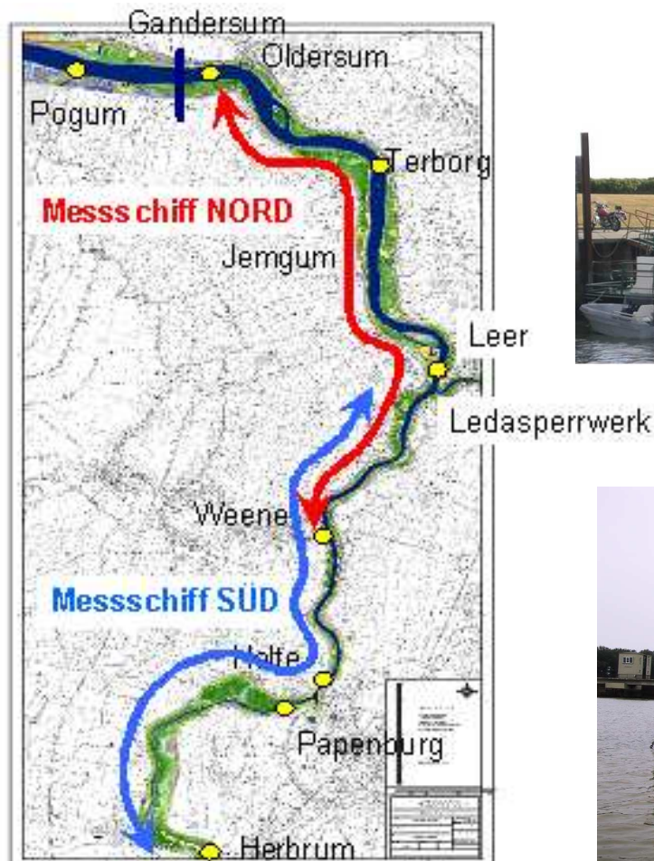
Skizze der Fahrtstrecken der Messschiffe MS Seehund (Nord) und MS Dobbe (Süd)
