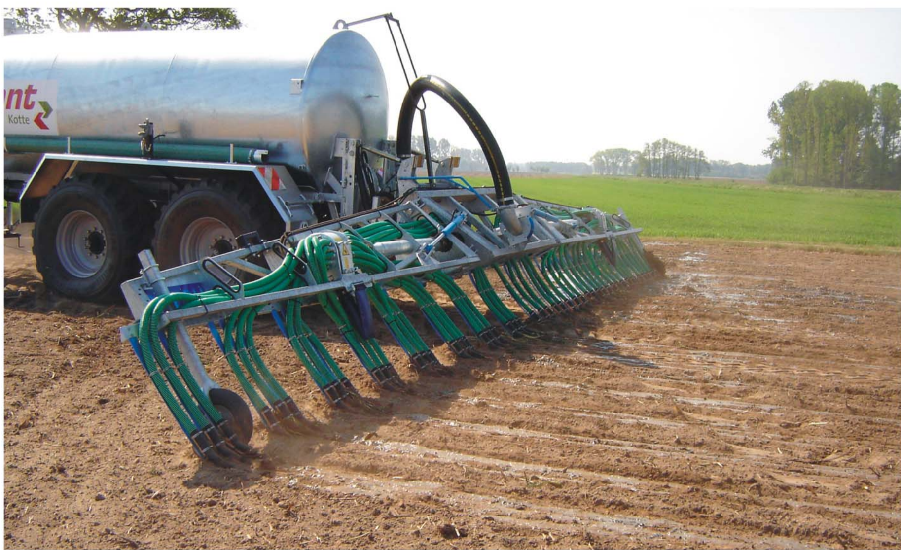
Foto: NLWKN. Neue Methode zur Gülleausbringung: Der Schleppschuhverteiler soll eine bessere Nährstoffausnutzung sicherstellen.
