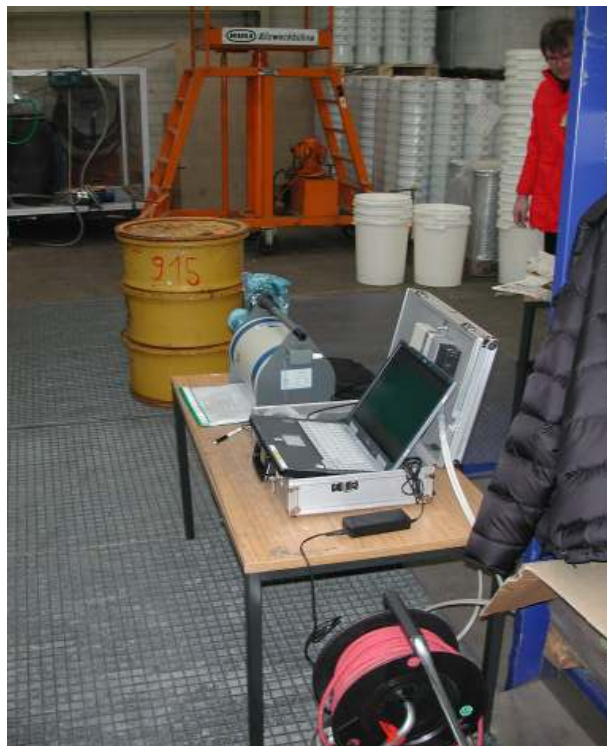
Zerstörungsfreie Überprüfung von radioaktiven Stoffen in einem Abfallgebinde
