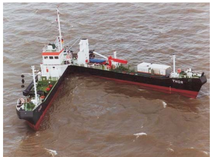
Spezialschiff "THOR" mit aufklappbarem Rumpf
