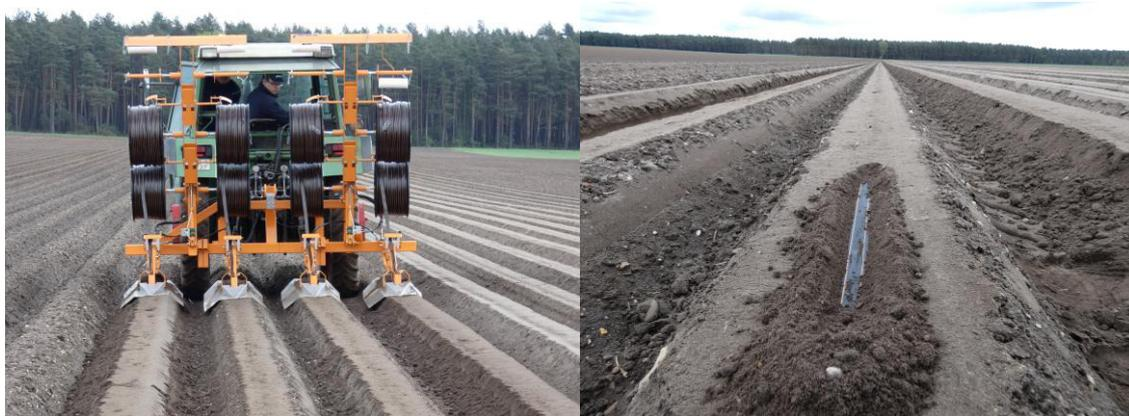
Abb. 12 Tropfrohrverlegung (4-reihig) in Kartoffeldamm mit neu entwickelter Maschine
