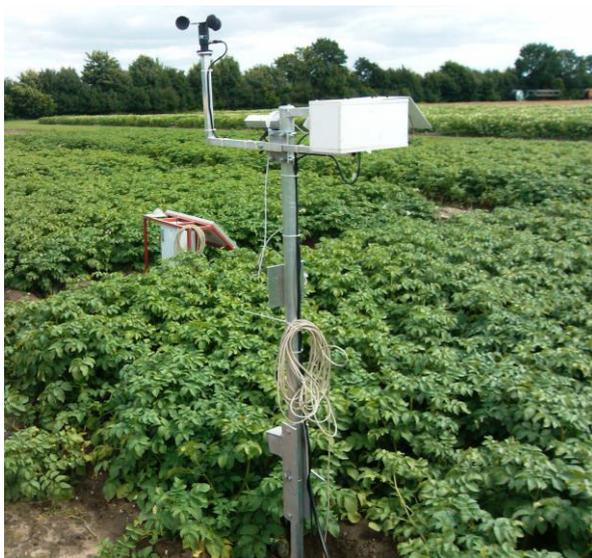
Abb. 14 Infrarot-Temperatur-Sensor misst Blatttemperatur an der Oberfläche des Kartoffelbestandes
