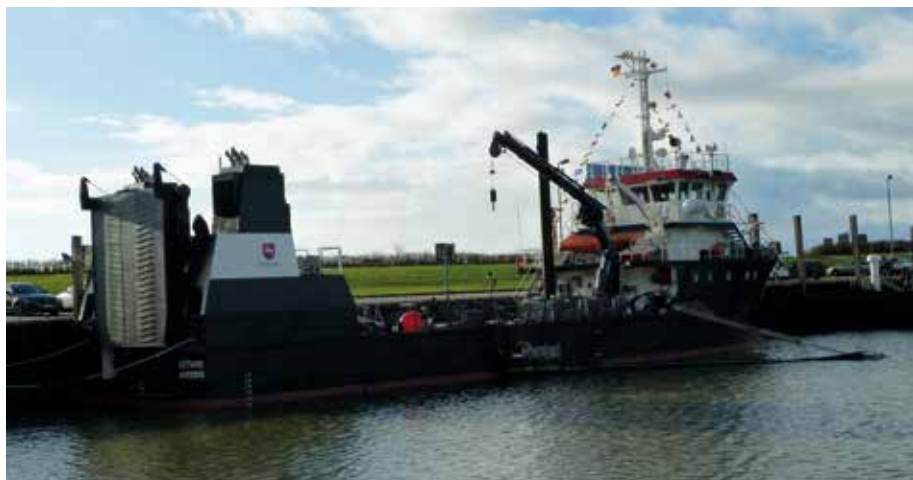
Die „Leysand“ im Hafen von Norddeich mit Falt-Heckrampe und ausgefahrenem Ölwehrsystern vom Typ „LAMOR“.
