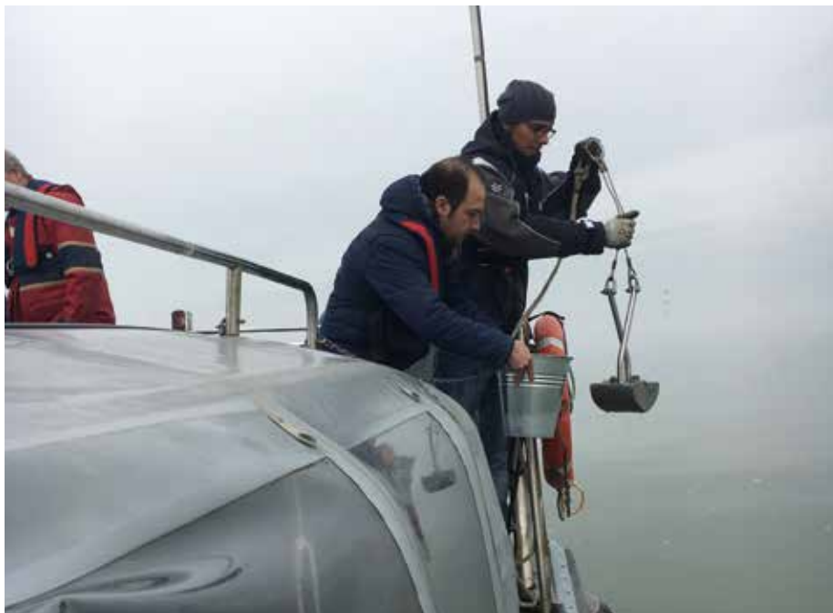
Auf dem Jadebusen im Einsatz: Mit dem Van-Veen-Bodengreifer und anderem Spezialgerät untersuchen Dennis Oberrecht (li.) und Gholamreza Shiravani von der Forschungsstelle Küste des NLWKN die verschiedenen Wasser-Grenzschichten.
