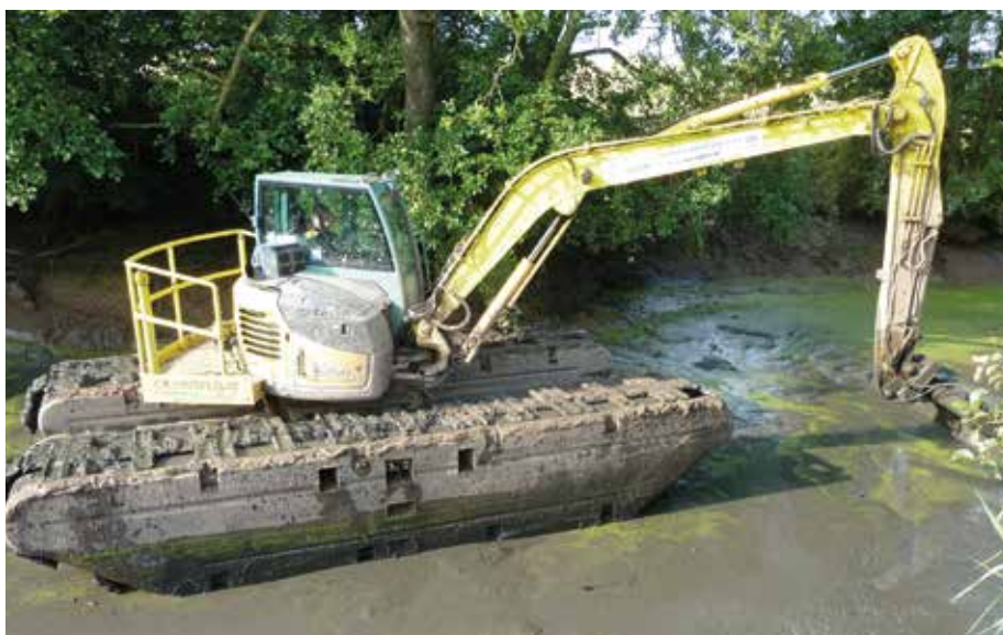
Die Rhüme: Mit Hilfe eines Baggers, der sowohl schwimmen als auch fahren kann, wurden die Sedimente auch in Bereichen mit dichtem Bewuchs schonend entnommen.
