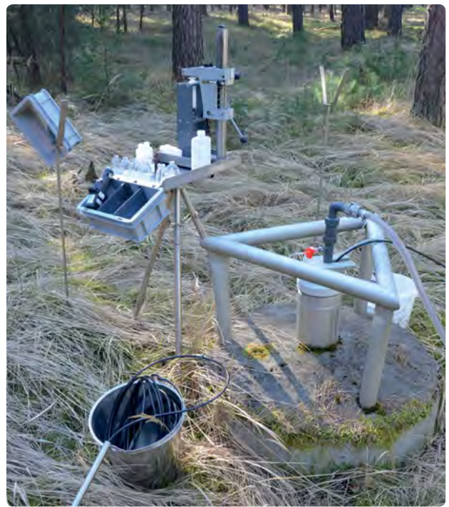
Das Grundwasser wird niedersachsenweit beprobt und sowohl vor Ort als auch im Labor untersucht (hier Probenahme für chemische und physikalische Analysen).
