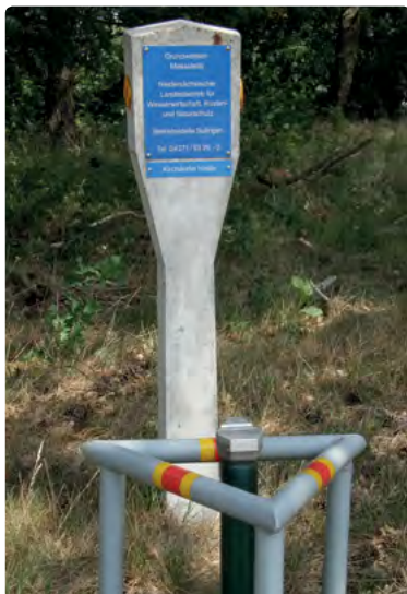
Im Untergrund ermitteln – An Grundwassermessstellen werden die Daten für die Ermittlung des chemischen und mengenmäßigen Zustands erhoben.
