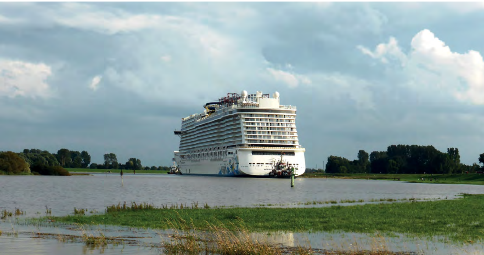
Schiffsüberführung auf der Ems. Damit die Kreuzfahrtschiffe in die Nordsee überführt werden können, wird die Ems zeitweise aufgestaut.
