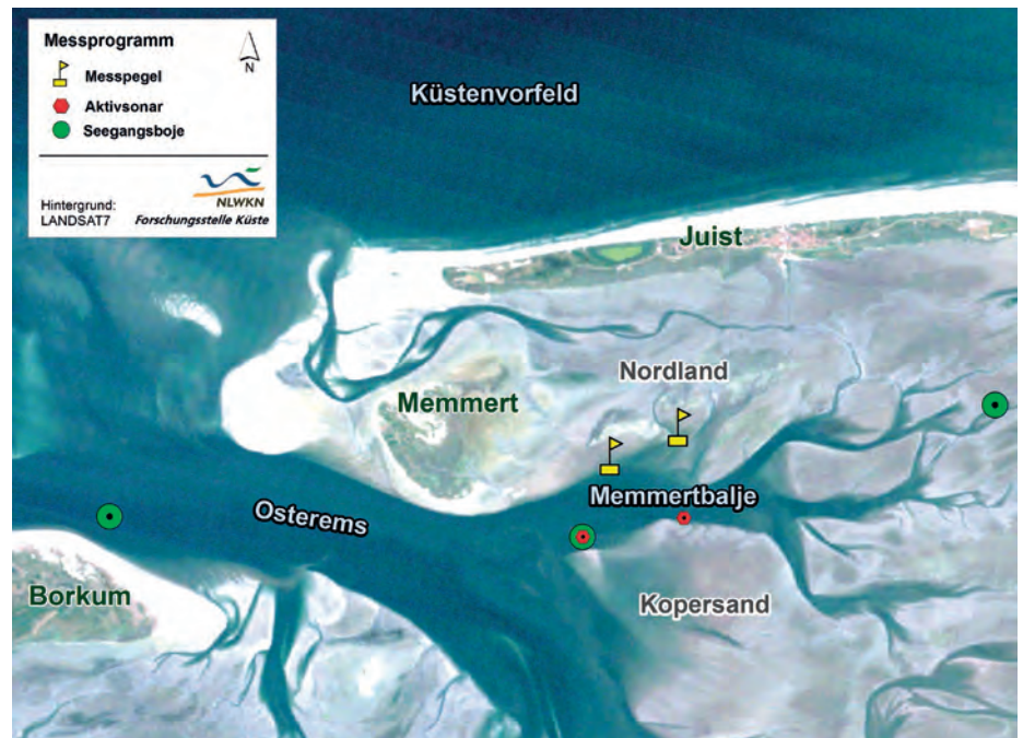
Die Karte zeigt die Positionen der unterschiedlichen Messgeräte zur Erfassung der Seegangsausbreitung im Inselfschatten von Juist.
