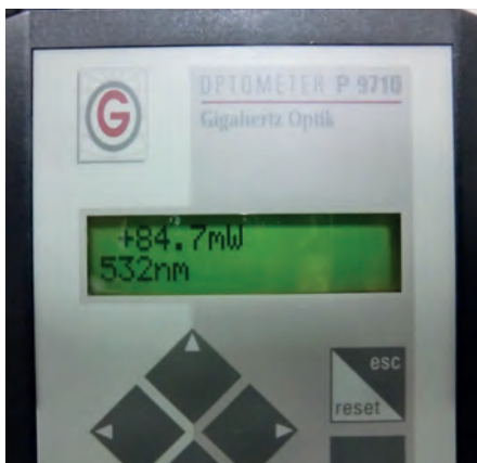
Das Ergebnis der Untersuchung: Der Leistungsgrenzwert der Laserklasse 2 von 1 mW ist deutlich überschritten.
