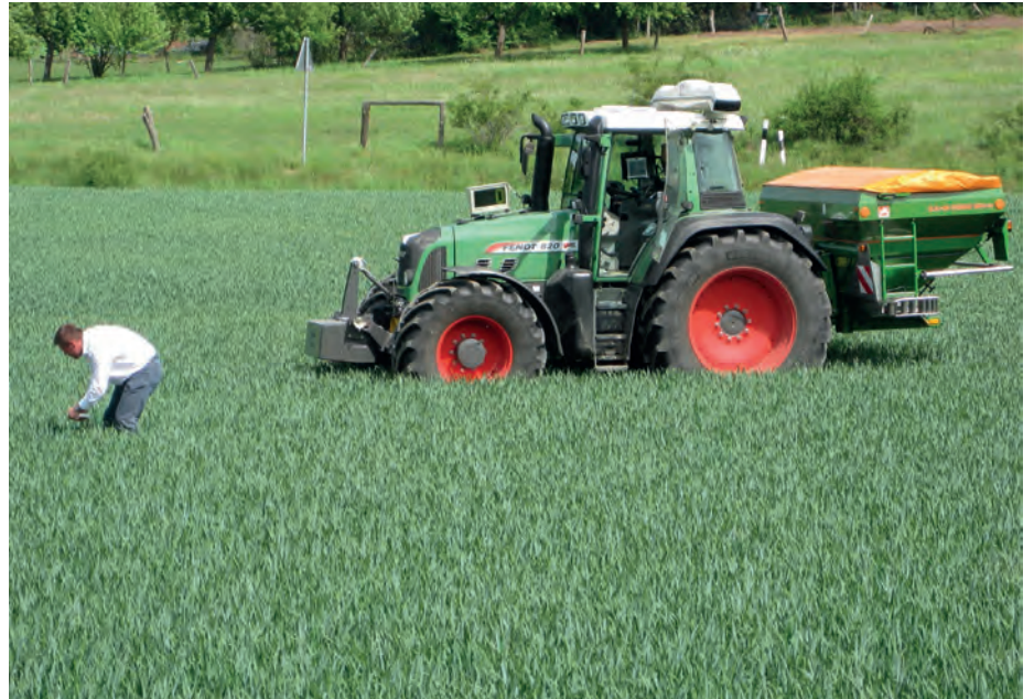
Düngerstreuer mit N-Sensor zur bedarfsgerechten Stickstoffdüngung – das schont das Gewässer.
